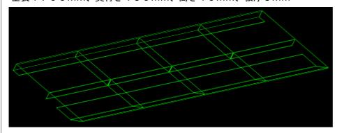
両端固定状態にて、自重30kgによる分布荷重および上面に40kgfの分布荷重を付加
